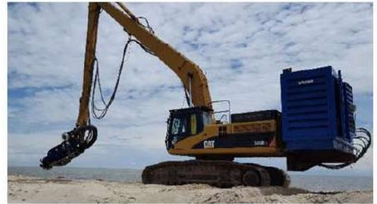
**El Accesorio de la Bomba de Dragado en Excavadora de EDDY** son bombas sin atascos, diseñadas para bombear material industrial alto en sólidos. Nuestra tecnología de bombeo patentada supera a todas las bombas centrífugas, de vórtices y desplazamiento positivo en la más amplia gama de bombeos complejos.
